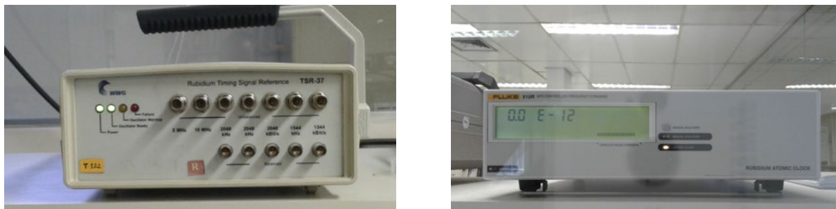
Figura 3 – Padrões de frequência de rubídio do Laboratório de Metrologia Elétrica do IPT
