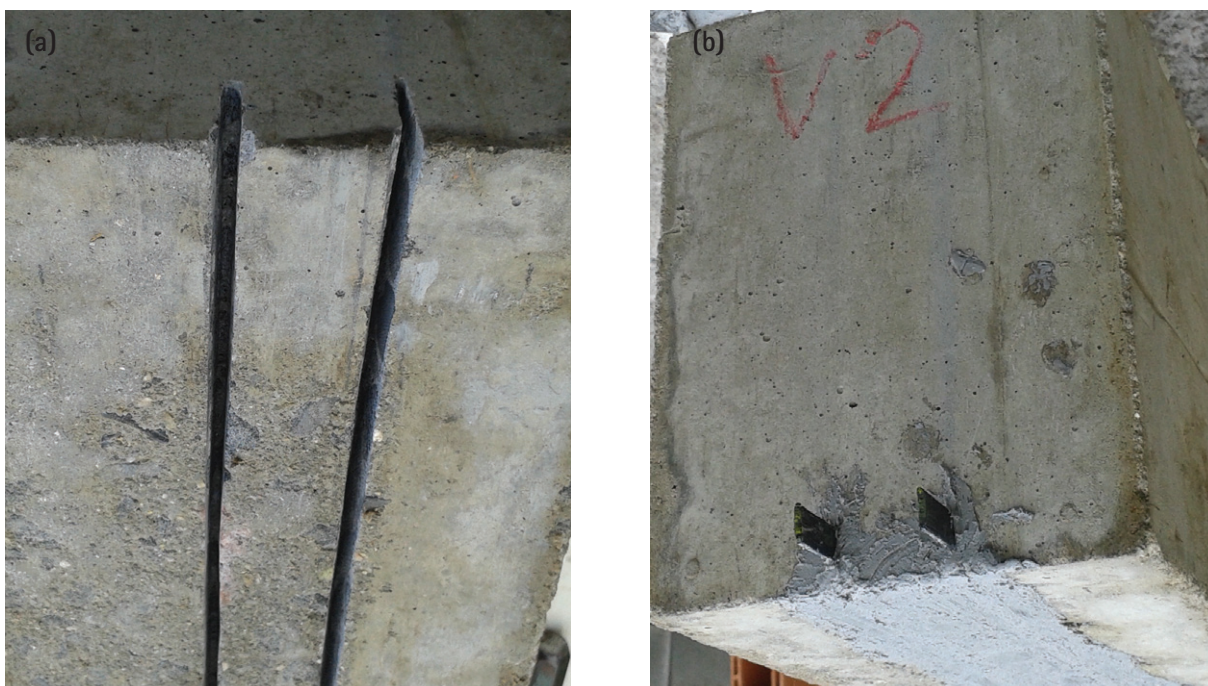
Figura 2 – Técnica NSM : (a) entalhes realizados no cobrimento de concreto da região tracionada da viga; (b) laminados de PRFC inseridos e colados nos entalhes realizados. Fonte: elaboração própria.
