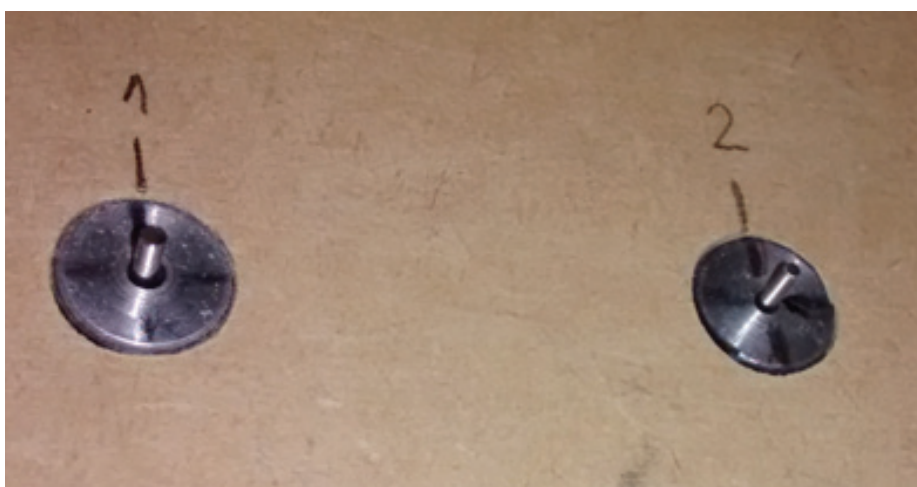
Figura 11 - Detalhes de sensores montados em placa plana da saída do túnel de vento. Fonte: elaborado pelos autores.
