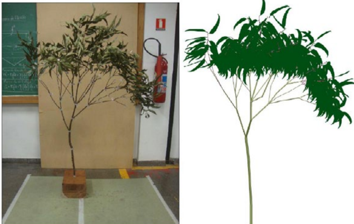
Figura 2 – Galho de eucalipto, no laboratório e o modelado no AutoCadTM para determinação da área vélica
