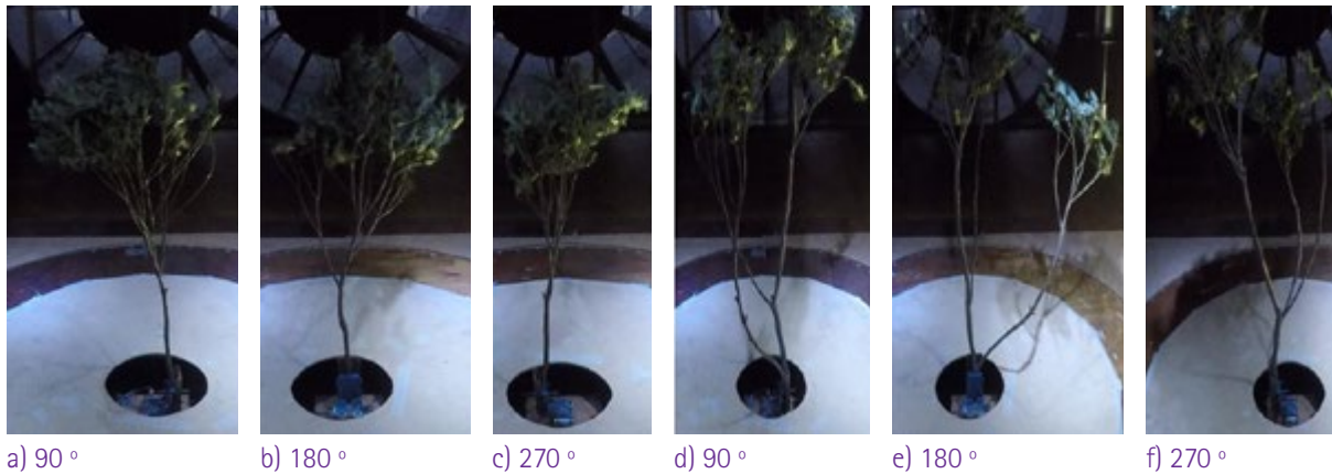
Figura 4 – Ilustração do formato dos galhos de eucalipto (a,b,c) isolado e (d,e,f) ramificado duplo para os ângulos de incidência do vento de 90°, 180° e 270°
