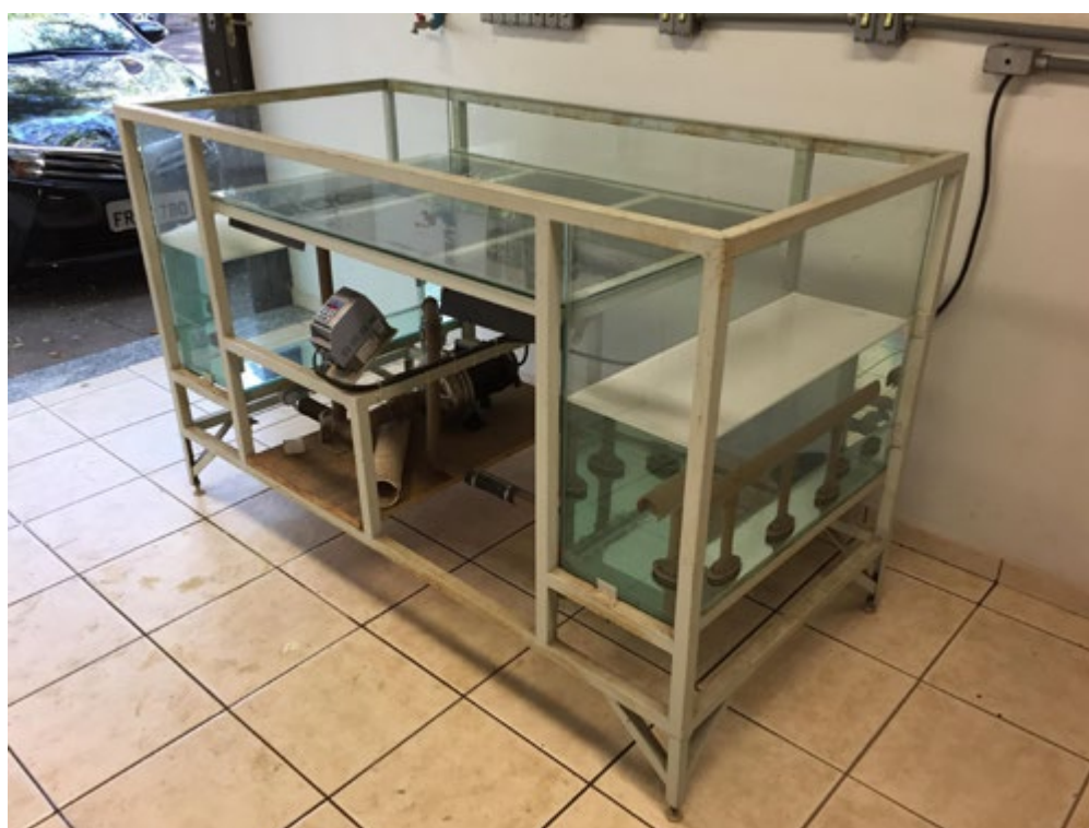
Figura 1 - Mesa d'água do Laboratório de Conforto Ambiental (LCA) do Instituto de Arquitetura e Urbanismo de São Carlos (IAU-USP)
