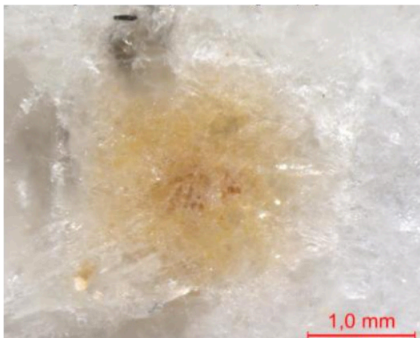
Figura 4 – Superfície polida do “Granito Branco Alpha”, selecionada para análise por MEV. Na foto a delimitação retangular riscada com ponta de widia (carbeto de tungstênio) é parcialmente visível.
