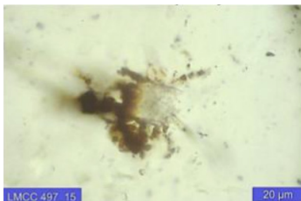
Figura 11 – Fotomicrografia do “Granito Branco Alpha”. Possível zircão associado a manchas de cor marrom. Polarização simples e condensador.
