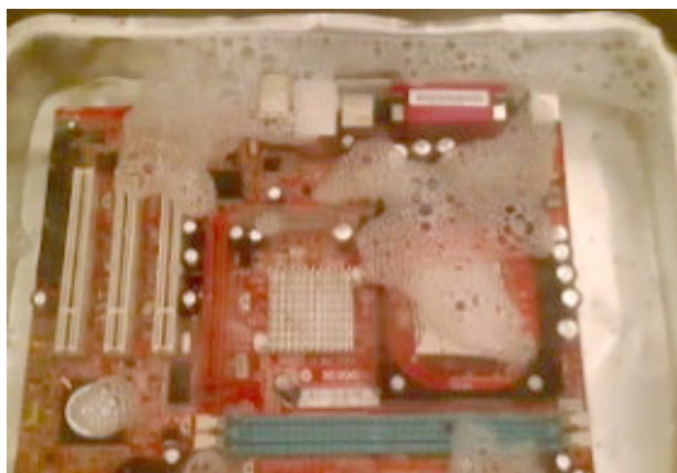
a) Placa recém mergulhada em solução de HCL
