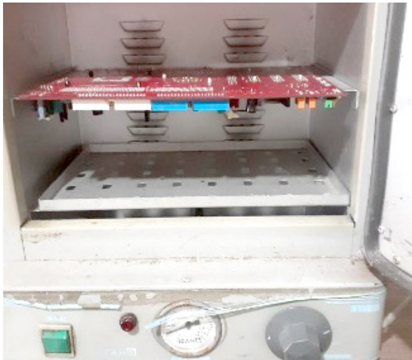
Figura 3- Placa suspensa pelas bordas acomodada no interior da estufa
