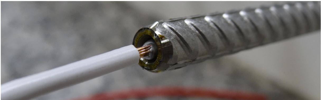
Figura 4 – Fio de cobre soldado para a conexão elétrica da barra de aço-carbono.
