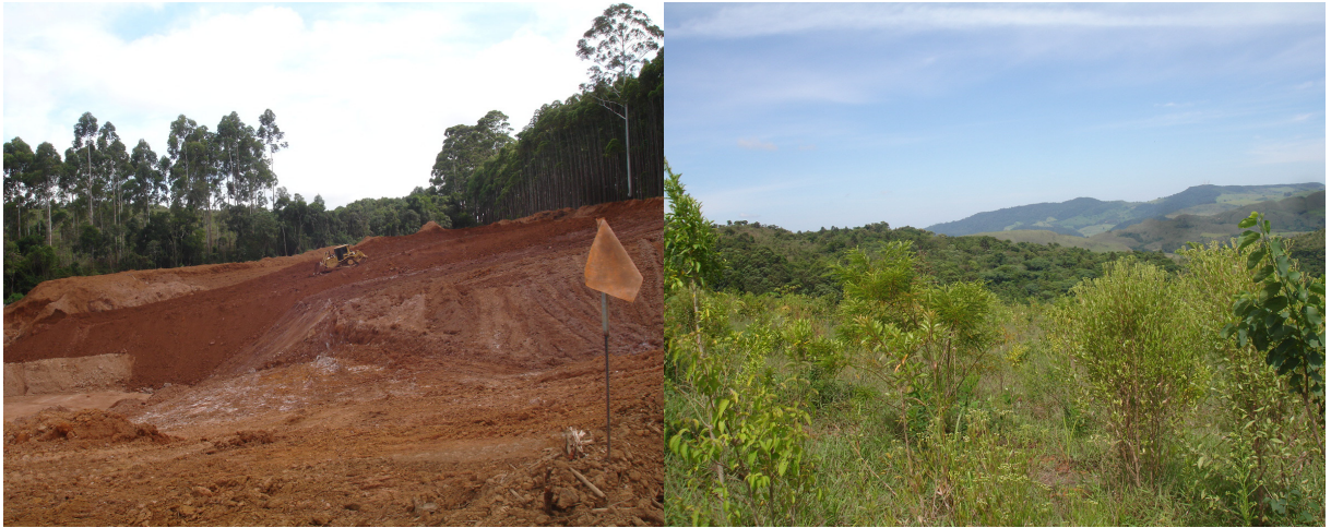
Figura 2 – Imagem à esquerda mostra área de lavra de bauxita sendo reconformada (trator no centro). À direita, área recuperada com espécies nativas em fase intermediária de crescimento.
