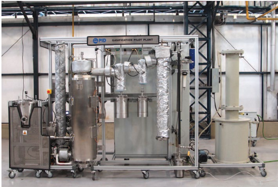
Figura 4 – Foto de equipamento de gaseificação e pirólise em escala laboratorial instalado no Laboratório de Engenharia Térmica do IPT.
