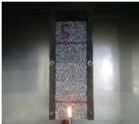
Fotografia 2 – Ensaio para a verificação da ignitabilidade do material
