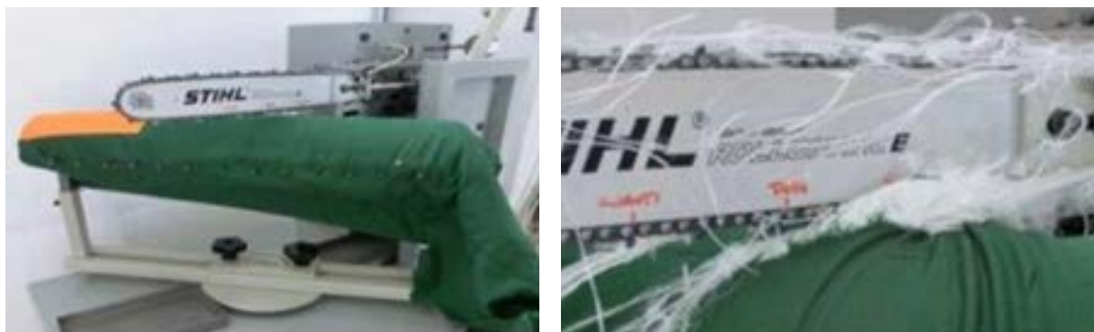
Figura 5 – Ensaio de corte por motosserra sendo realizado
