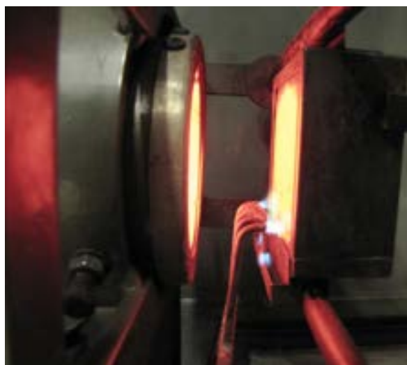
Fotografia 4 – Ensaio para a determinação da densidade óptica de fumaça do material
