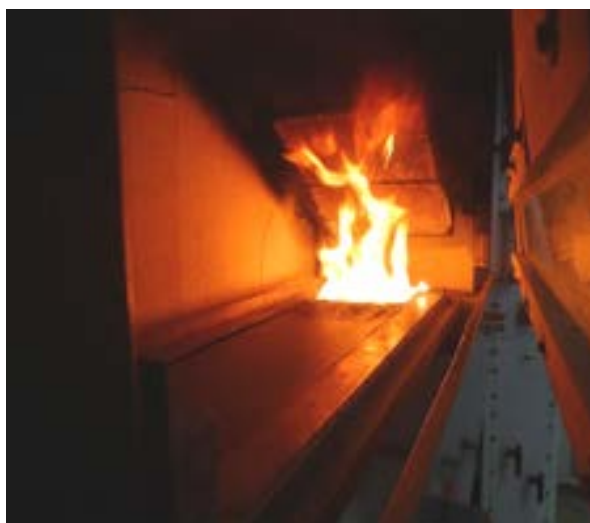
Fotografia 3 – Ensaio para a determinação do fluxo crítico de energia radiante do material
