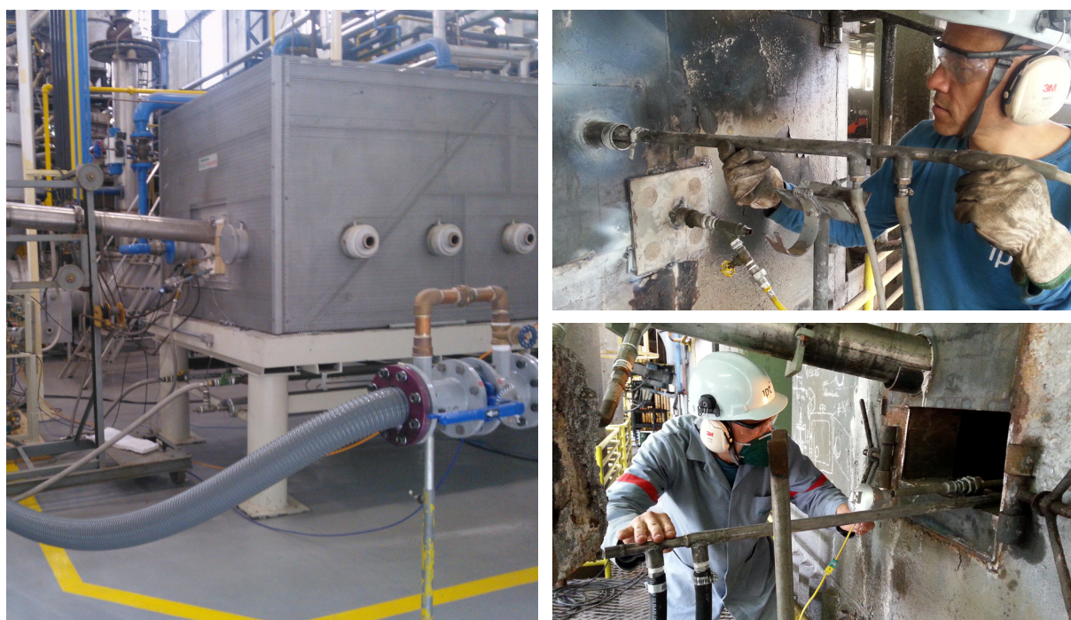
Figura 4 - Emprego da oxi-combustão em fornos de fusão de chumbo.
