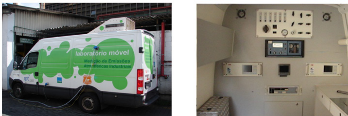
Figura 15 – Unidade móvel do LBE com analisadores de gases montados em seu interior
