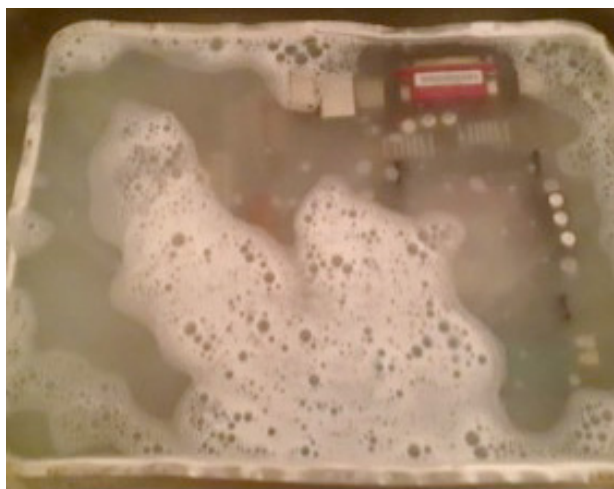
b) Ácido clorídrico corroendo a solda após alguns minutos
