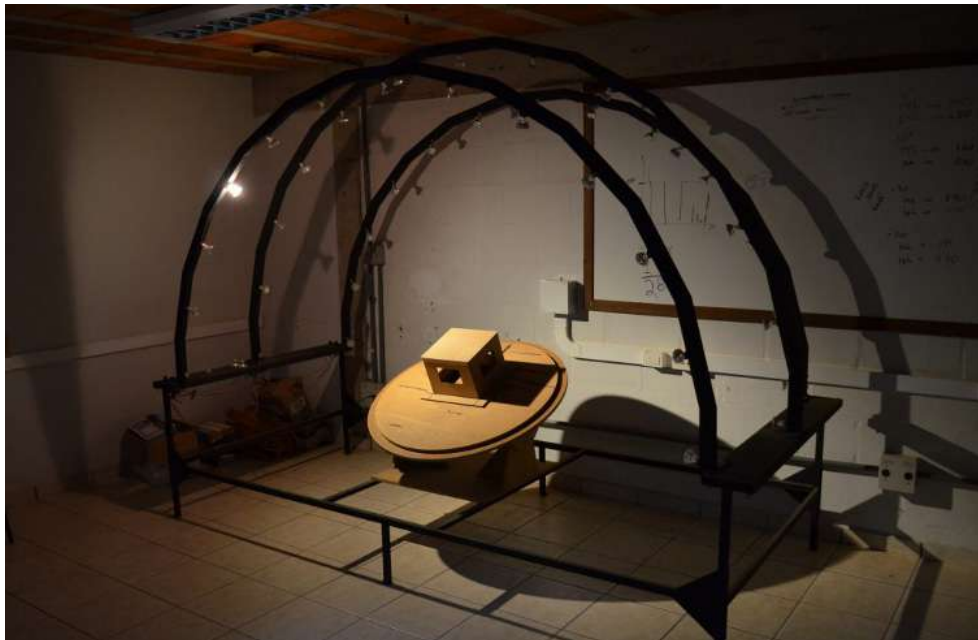
Figura 2 - Heliodon de arcos fixos com mesa móvel do Laboratório de Conforto Ambiental da USP.
