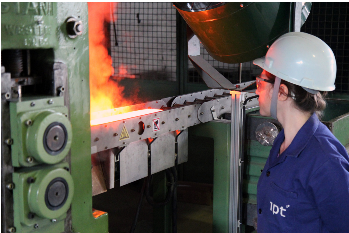
Laminador-piloto automatizado com capacidade de 50 tf
