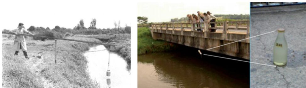
Figuras 17 e 18 – Exemplos de procedimentos utilizados em coletas tradicionais. Notar a dependência de aparatos fixos e pontes.
