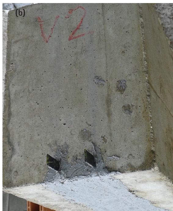
Figura 2 – Técnica NSM : (a) entalhes realizados no cobrimento de concreto da região tracionada da viga; (b) laminados de PRFC inseridos e colados nos entalhes realizados. Fonte: elaboração própria.
