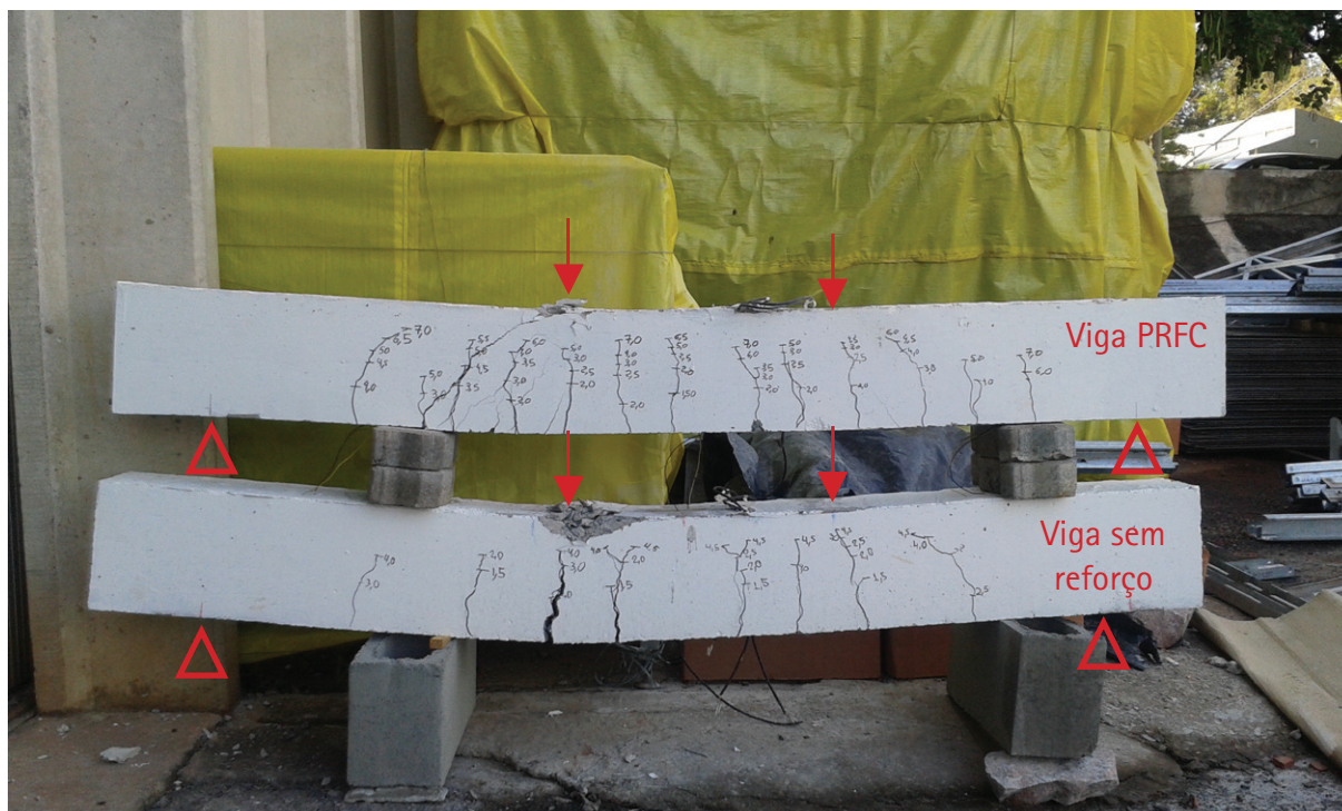
Figura 12 – Fissuração nas vigas ensaiadas após a ruína. As setas indicam a localização dos pontos de aplicação de força durante os ensaios e os triângulos indicam os locais onde foram apoiadas as vigas. Fonte: elaboração própria.
