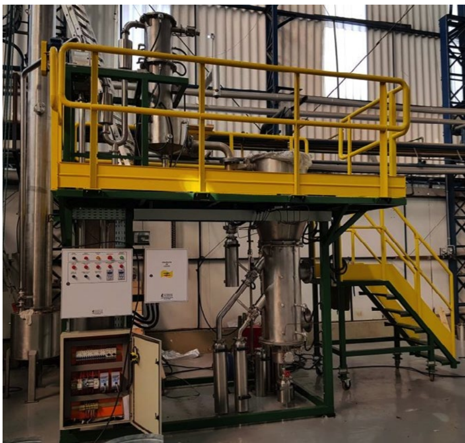
Figura 3 – Foto de reator de leito fluidizado borbulhante para ensaios de combustão de resíduos em escala laboratorial instalado no Laboratório de Engenharia Térmica do IPT. Fonte: elaborado pelos autores.
