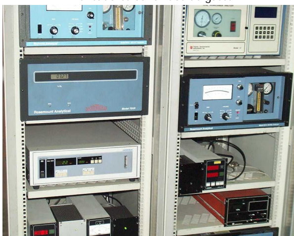
Analisadores contínuos de gases
