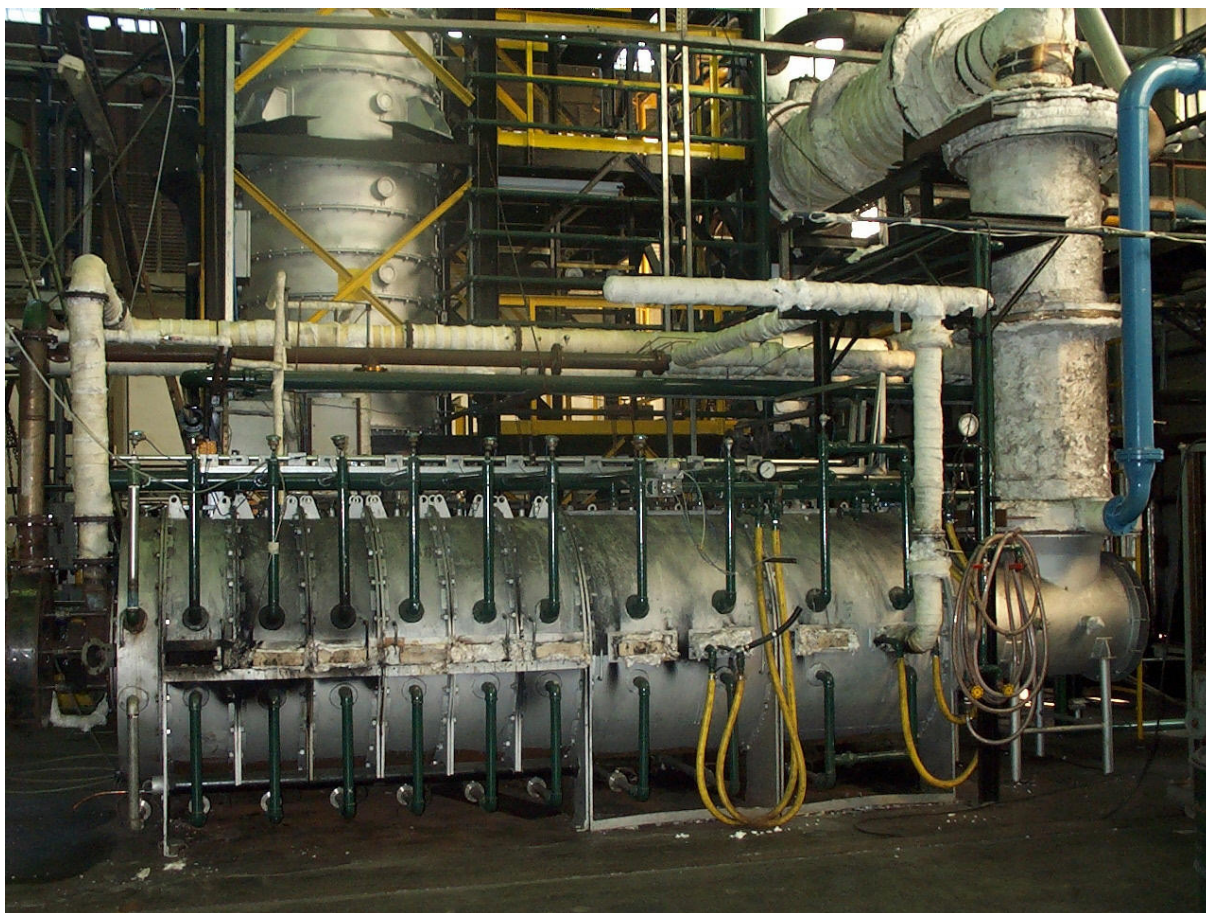
Figura 2 - Fornalha cilíndrica horizontal de testes do Laboratório.
