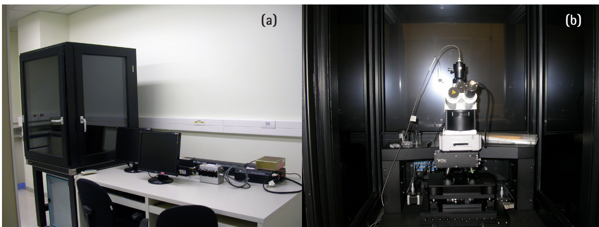
Figura 2 - (a) Espectrofotômetro Raman Confocal da marca WiTec modelo alpha 300R e (b) detalhe da parte interior do equipamento mostrando o microscópio ótico e focalização do laser.
