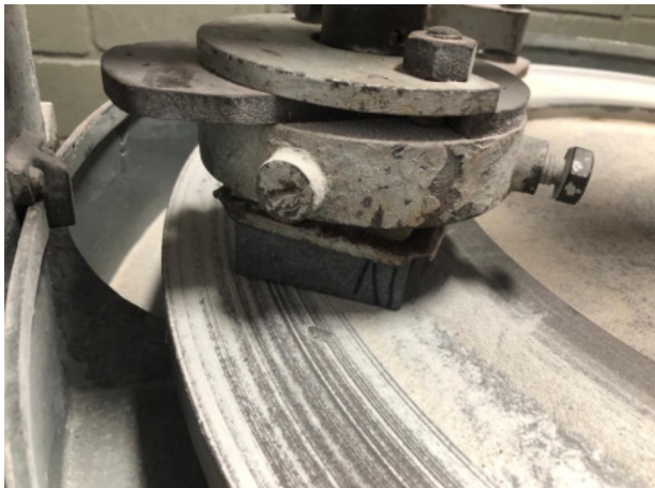
Figura 4 – Ensaio AMSLER em execução com amostra de Granito Preto São Gabriel.
