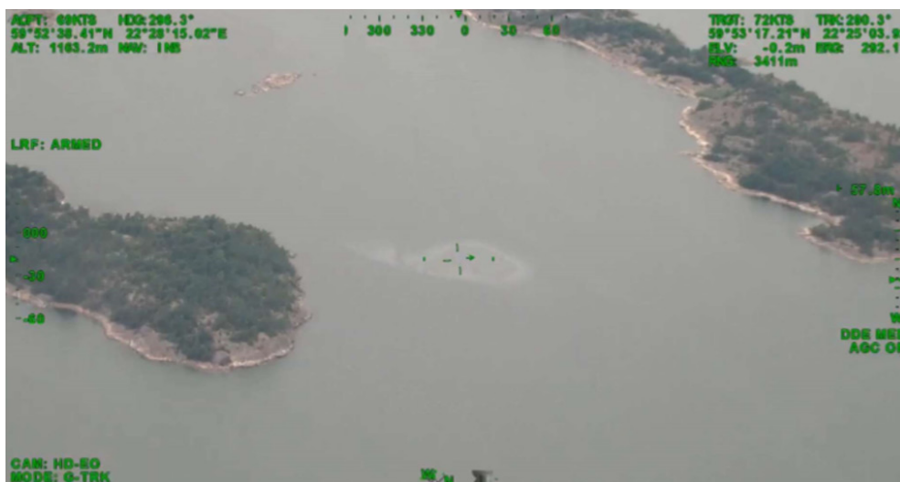
Figura 3 – Exemplo de derramamento superficial de óleo em área costeira identificado por drone.
