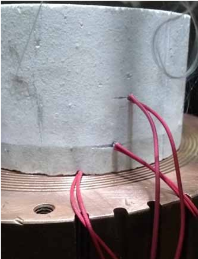
Figura 3 - Termopares afixados a parede do anel de contenção de alumina.
