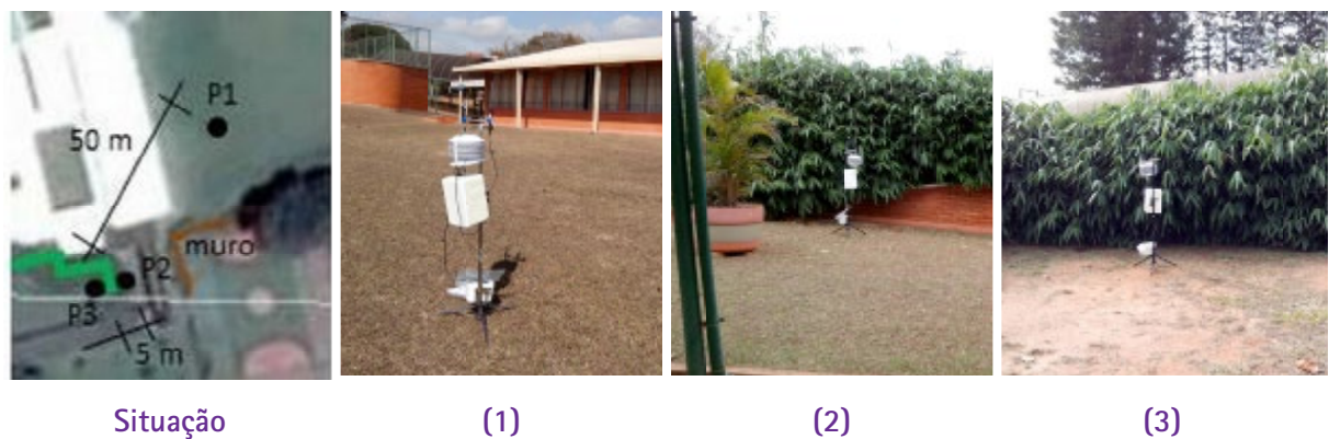
Figura 3 – Bambu no Bloco de Ed. Física nos pontos (1) em campo aberto, (2) antes da barreira e (3) após a barreira
