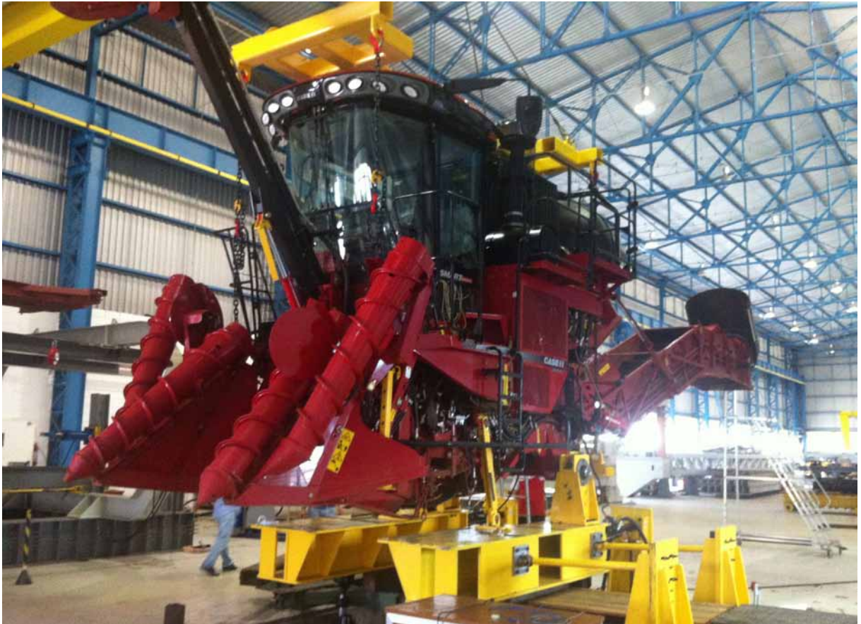
Figura 3 – Exemplo de bancada com seis atuadores.
