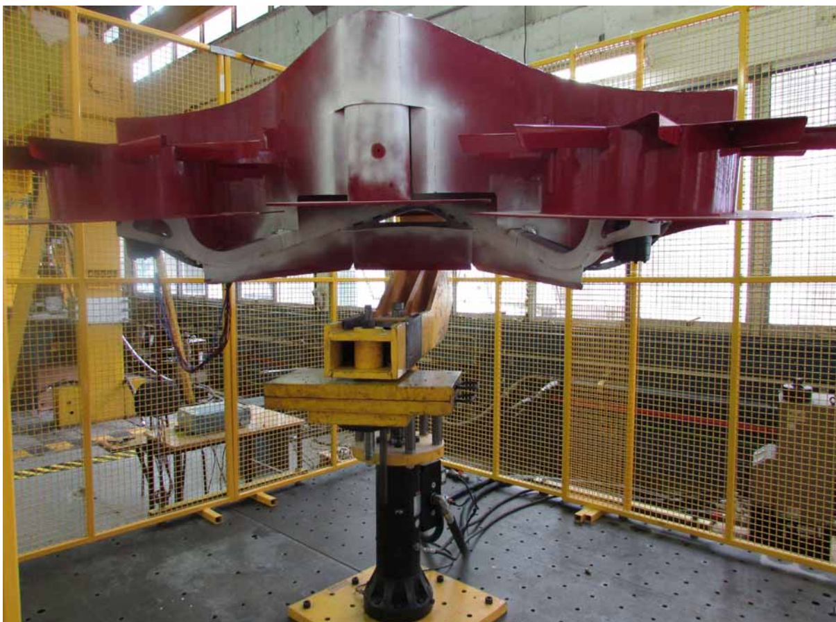
Figura 2 – Exemplo de bancada de um único atuador.
